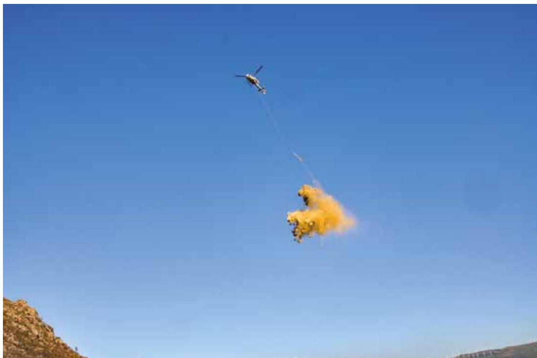
Figura 59. Helimulching en el incendio de Monte Pindo( A Coruña) de 2013
