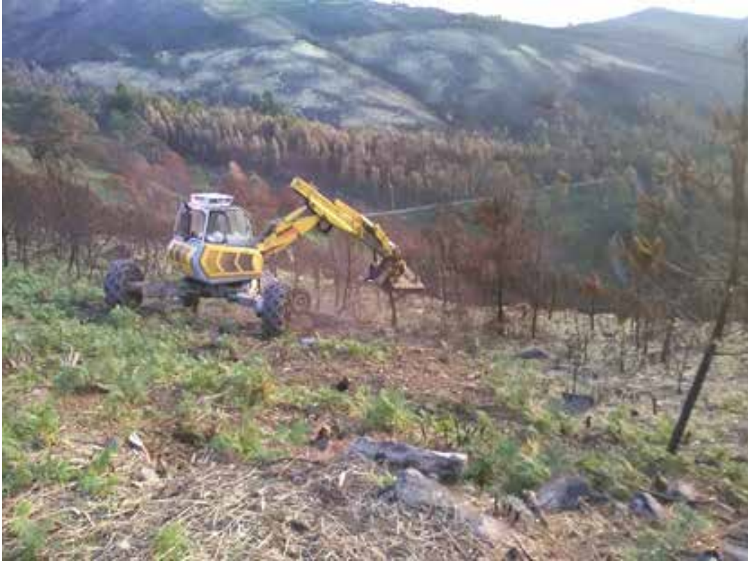
Figura 53. Trituración del arbolado quemado, sin aprovechamiento comercial por su escaso tamaño, efectuada con retro-araña en el incendio de Arbo (Pontevedra) de 2016. Al fondo zonas tratadas con helimulching.
